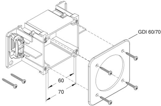
2. Die Industrie-Geräteeinbaudose GDI 60/70 in die Deckelaufnahmekontur des Gerätekanalunterteils einsetzen.
