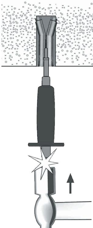
4. Bei korrekter Montage hinterlässt das Setzwerkzeug eine Markierung.
